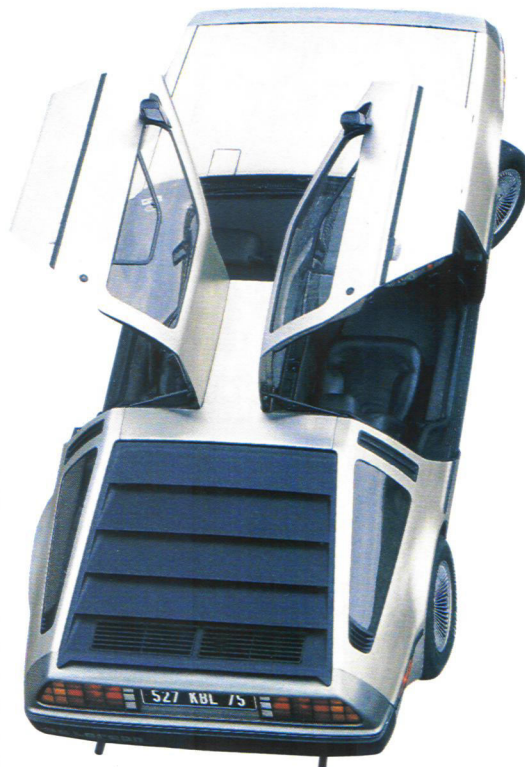
Châssis-poutre inspiré de la Lotus Esprit 1 re série, coque inox et structure en fibre de verre, la De Lorean se distingue aussi par ses spectaculaires portières "papillon".
