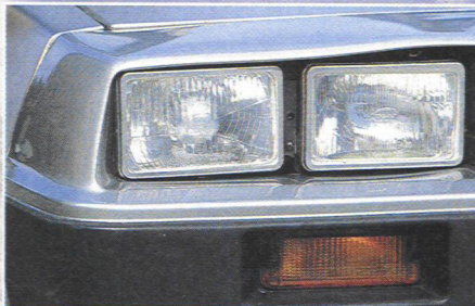
Die Scheinwerfer sitzen in einer Kunststofffront, die kleinere Remppler schadlos wegsteckt
