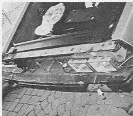
Gummitteile wie Dichtungen gehören auch beim DeLorean zu den typischen Schwachpunkten
